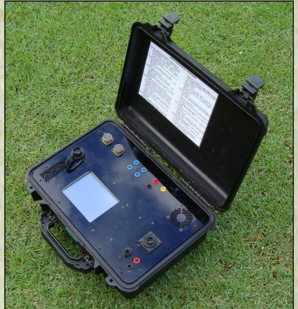
Per energizzare la vasca ed effettuare le misure viene utilizzato un sistema di immissione di corrente controllata. In corrispondenza di ogni stazione vengono eseguite le misure di campo elettrico con inversione di polarità della corrente.
